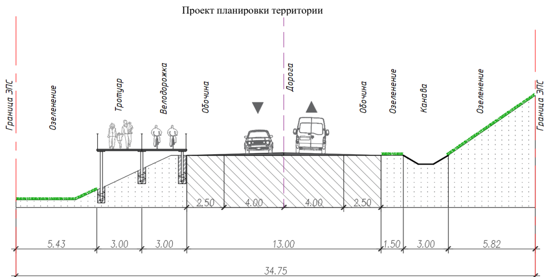
Рис. 3.1.2.4-1 Разработанный проектом поперечный профиль автомобильной дороги с велосипедным маршрутом на свайном фундаменте
